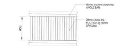
STEEL GRATING DETAILS SCALE: 1/4" = 1'-0" N.T.S.
